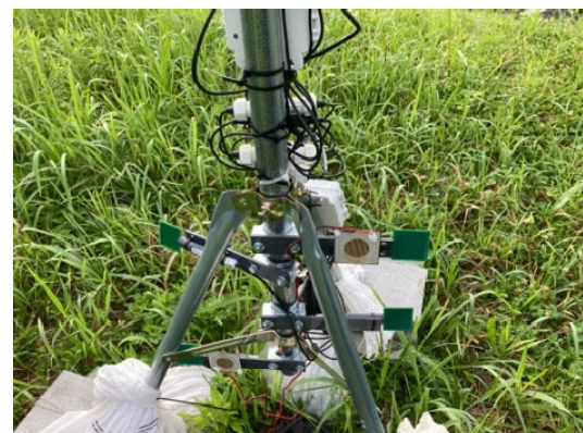
図 1 濡れ時間観測センサの設置状況
